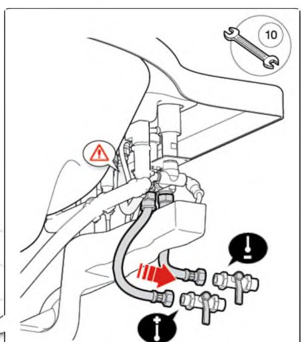
Instalar el dispositivo de protección contra reflujo, dependiendo de la normativa local vigente. Para cumplir con la norma EN-1717, Instalar la referencia Roca: A248312000
