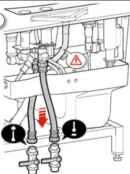
Instalar el dispositivo de protección contra reflujo, dependiendo de la normativa local vigente. Para cumplir con la norma EN-1717, instalar la referencia Roca: A248312000
