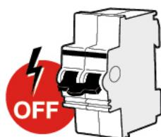
**ES** Antes de reemplazar el mecanismo, cortar la alimentación eléctrica del inodoro.
