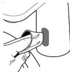
**ES** Limpiar el grifo solo con detergentes líquidos no ácidos. No utilizar ningún tipo de estropajo. Mantener limpio el visor cuidando de no rayarlo.
